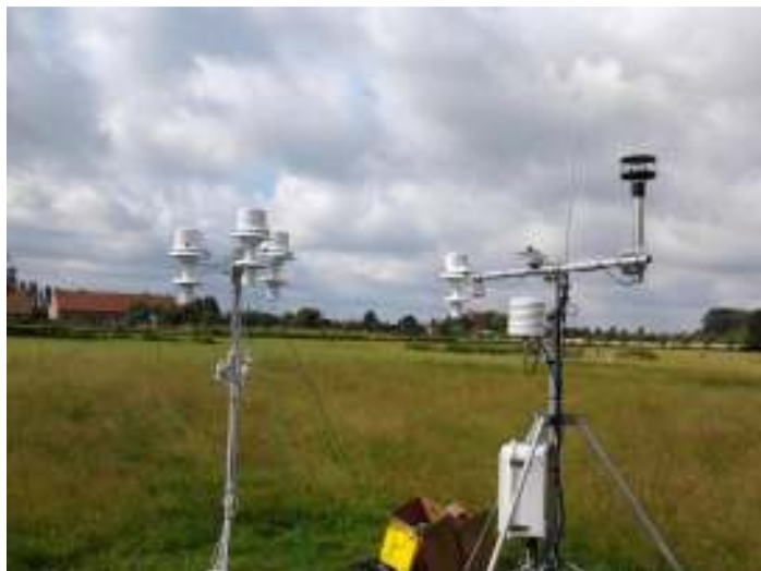
Figuur 11 : Afbeelding van de calibratie opstelling voor de 3 HOBO sensoren die we in Gent hebben uitgezet. De sensoren bevinden zich in een identiek actief geventileerd stralingschild als de PT1000 sensor van het Campbell meteostation op de achtergrond.
