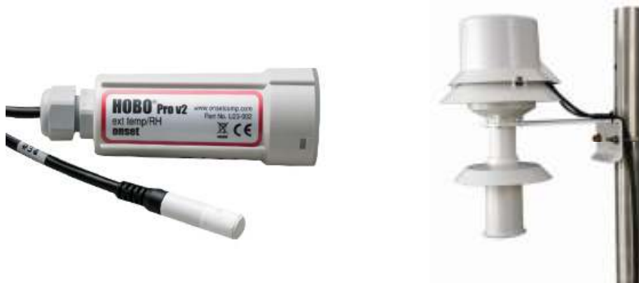
Figuur 3 : Links: afbeelding van de gebruikte Onset HOB0 U23-002 Pro v2, rechts: afbeelding van de actief geventileerde stralingshut van het type : Youngs 43502 aspirated radiation shield.
