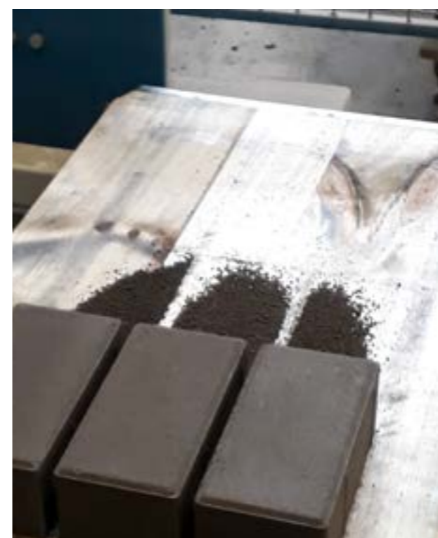
Figuur 2 Kleine klinkers (22x11x8 cm) testproductie
