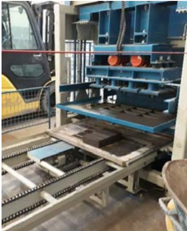
Figuur 3 Metalika-trilpers met Carbstone-klinkers voor Stapsteen
