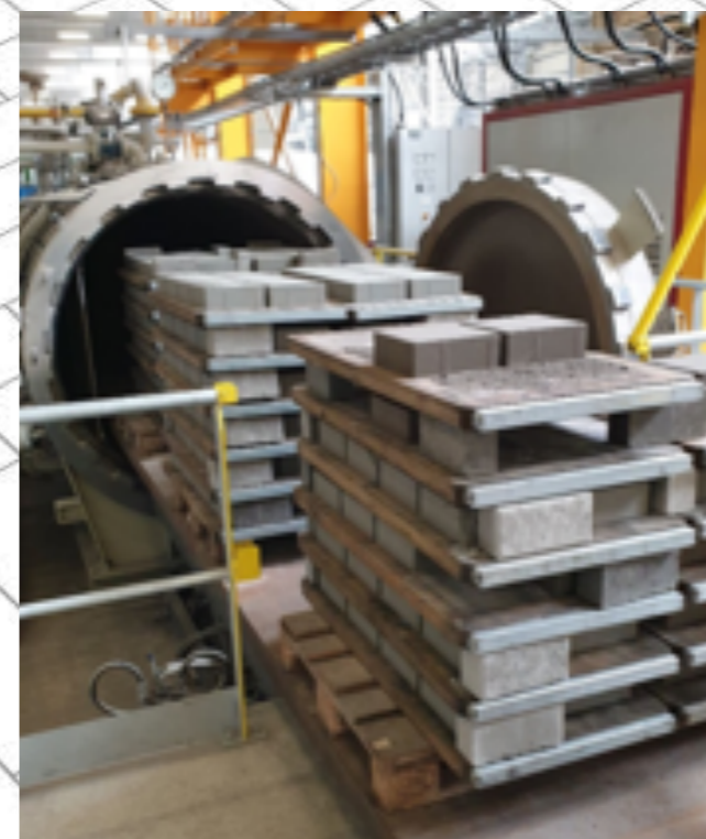
Figuur 4 Laden van de autoclaaf met Stapsteen klinkers voor de carbonatatiecyclus
