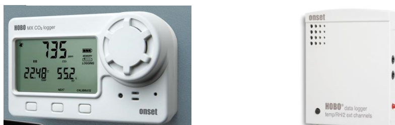
Figuur 20 Gebruikte meetapparatuur: HOBO MX1102 en HOBO U12-013
