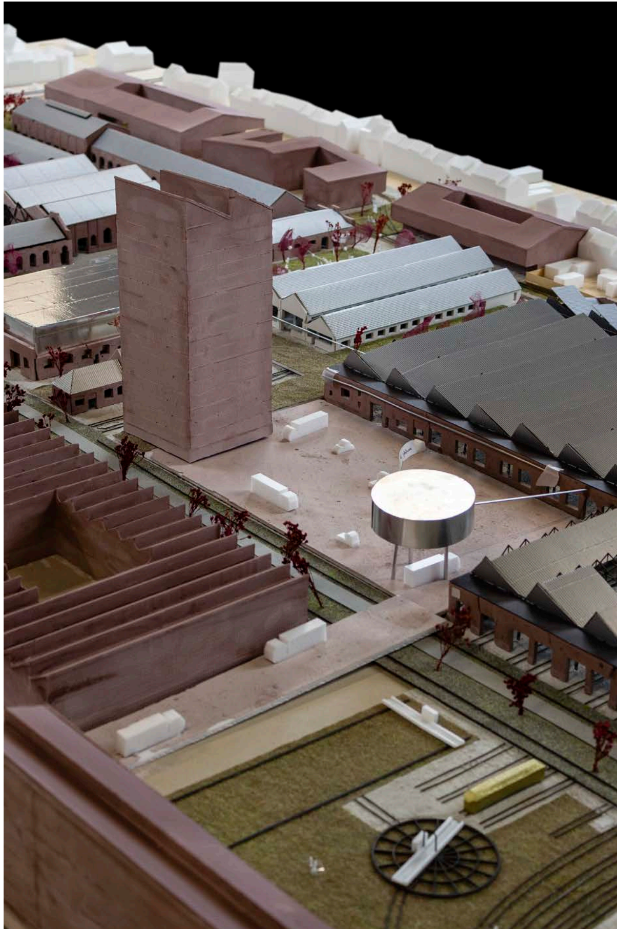
Zicht op het logistieke plateau dat door één welgekozen kruising met verkeerslichten, bereikbaar is vanop de Logistieke as. De regenwatertoren aan de rand van het logistiek platform verzamelt het regenwater van de loodsen voor herbruik. De Moscou woontoren is een baken halverwege de Arsenaal-as.
