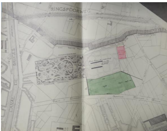
Plan bij gevoegd bij het bestek van januari 1922 (G/94/3/1922/2). Rood: het te verhogen gedeelte met oppervlakte van 2951 m 2 . Groen: stadseigendom waarvan de grond voor de aanvulling zal komen. Voetweg 35 is nog aangeduid, die zal in 1930 verdwijnen bij het vergroten van de begraafplaats tot aan de ringspoorweg. (Dossier grondwerken, SAG G/94/3/1922/2).
